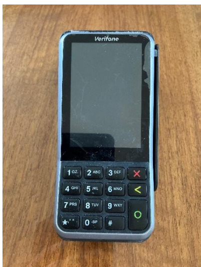
Bild 1–2 V400m, framsida med knappsats och kortläsare/kortinstick
