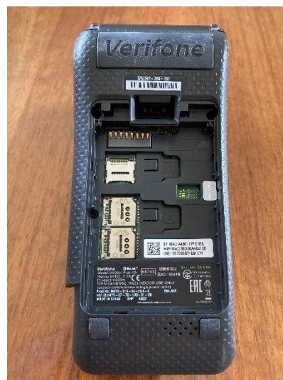
Bild 4–5 V400m, baksida innanmäte (utseende innanför avtagbar batterilucka)
