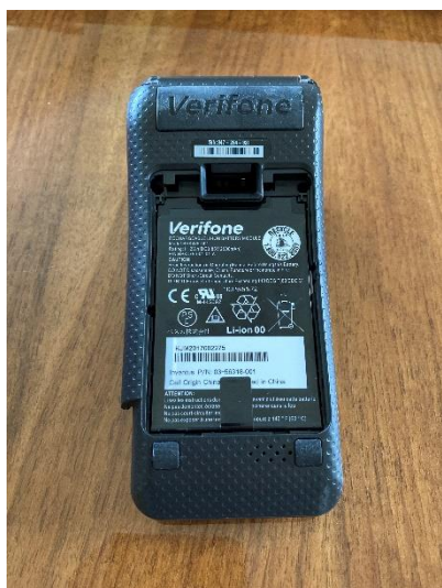
Bild 4–5 V400m, baksida innanmäte (utseende innanför avtagbar batterilucka)
