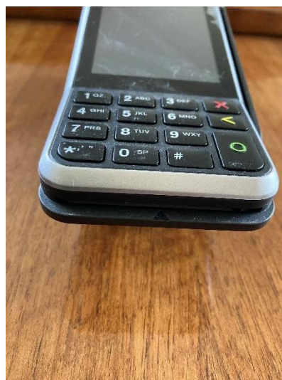
Bild 1–2 V400m, framsida med knappsats och kortläsare/kortinstick
