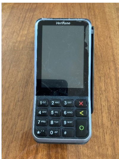
Bild 1–2 V400m, framsida med knappsats och kortläsare/kortinstick
