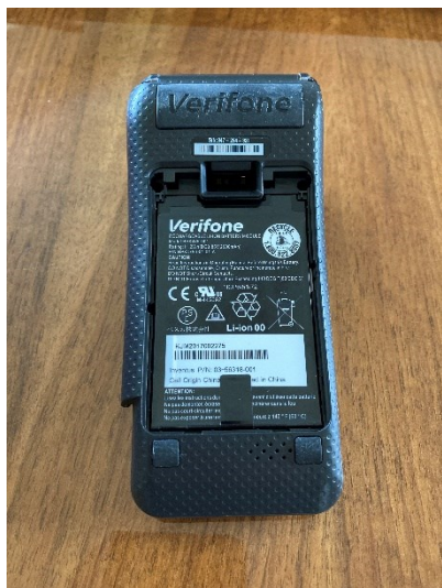
Bild 4–5 V400m, baksida innanmäte (utseende innanför avtagbar batterilucka)
