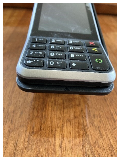
Bild 1–2 V400m, framsida med knappsats och kortläsare/kortinstick
