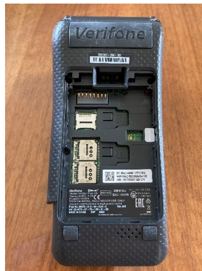
Bild 4–5 V400m, baksida innanmäte (utseende innanför avtagbar batterilucka)
