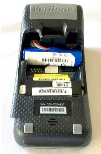
Bild 3–4 VX690, baksida inkl. innanmäte (utseende innanför avtagbar batterilucka)
