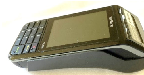
Bild 5–6 VX690, vänster och höger sida inkl. originalhål (uttag laddare) och originaldekal (Verifone)
