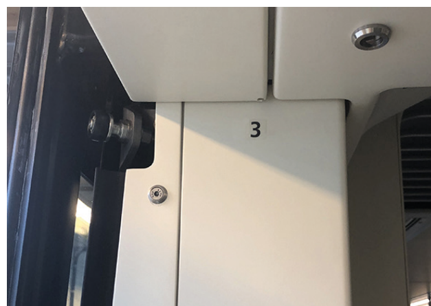
● 43 . Dörrnummer 2 - 6 (GS960832-2) Svart Placeras upptill vid höger sida av varje dörr.
