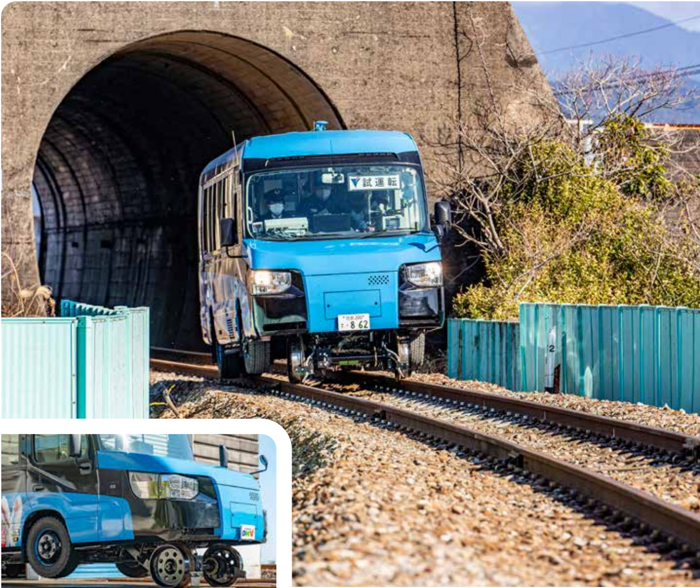
På bara 15 sekunder förvandlas de nya bussarna på ön Shikoku i Japan till tåg! Fordonen är utrustade med både gummidäck och stålhjul som gör att de kan köras på både vägar och räls.
